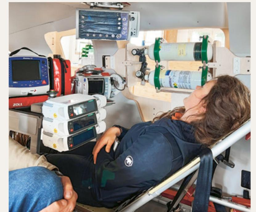
La maquette en bois permet de tester à loisir les modifications dans les conditions les plus réalistes possibles.
