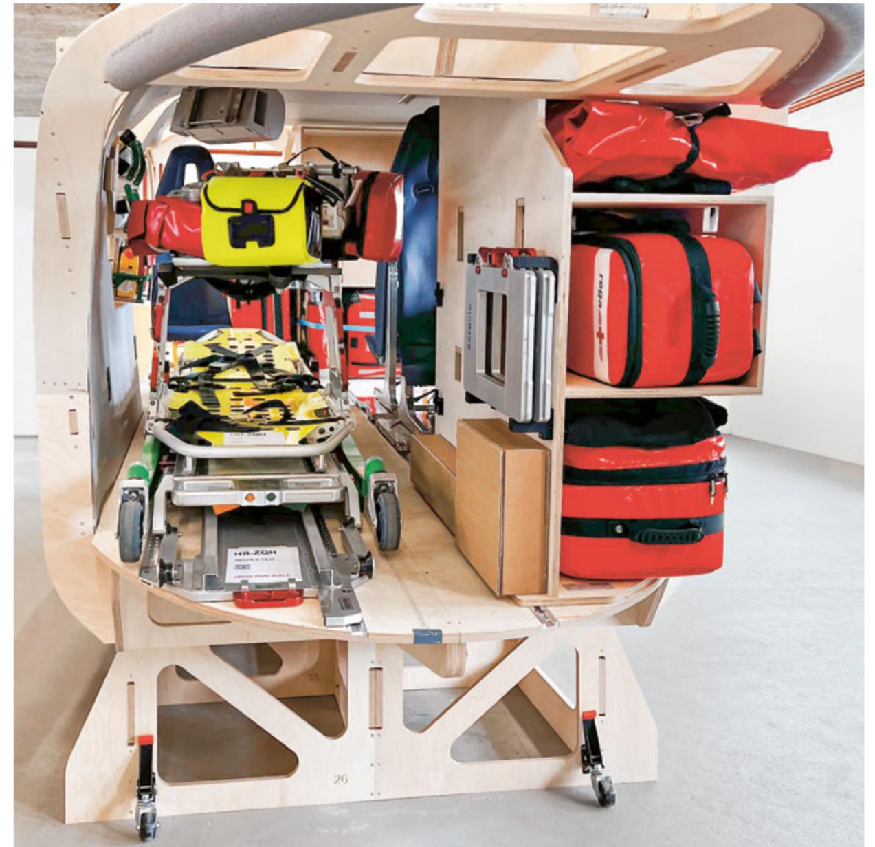
Pour tester les adaptations de la cabine, une maquette en bois a été construite à l'échelle 1:1.
