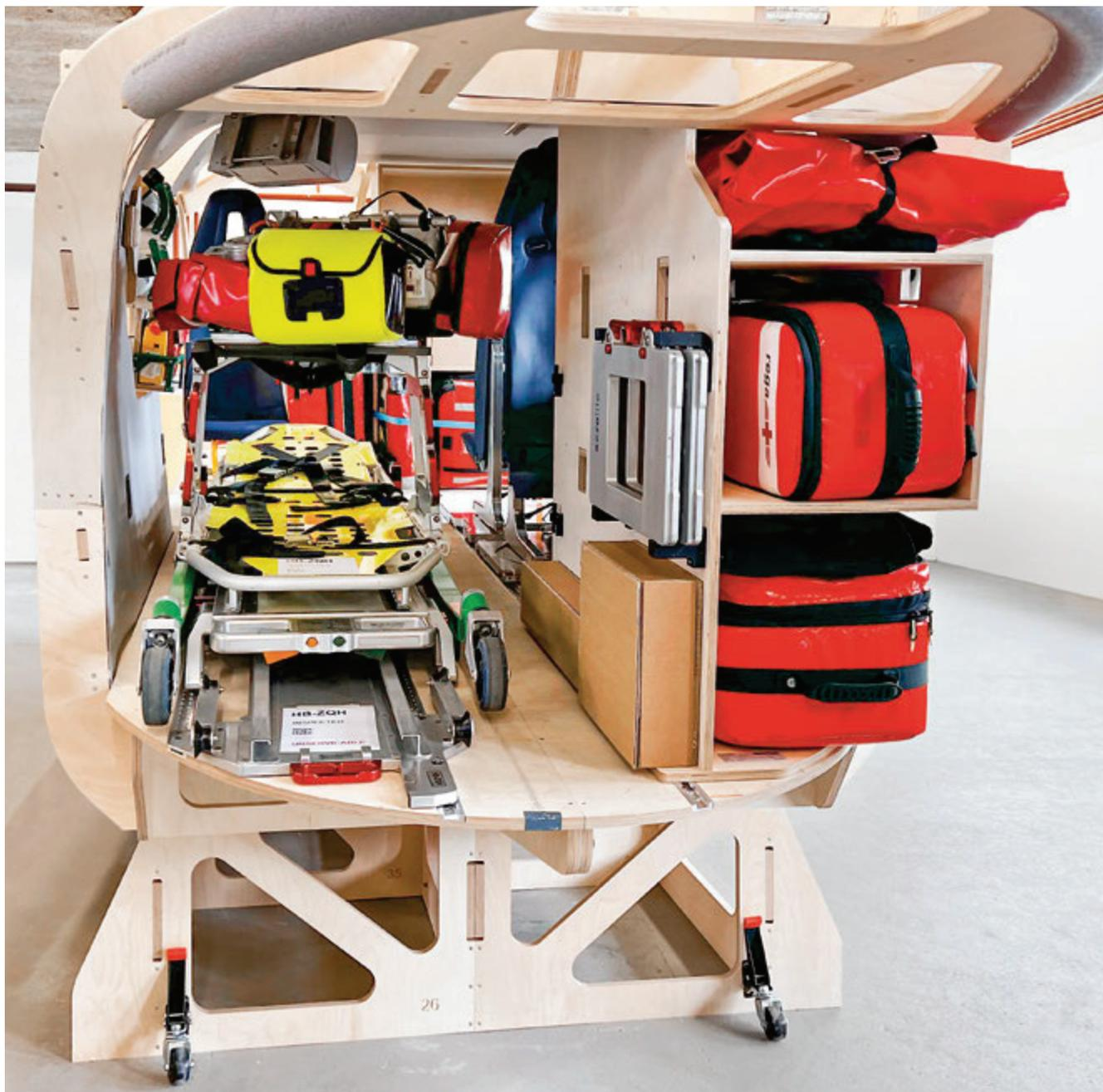
Pour tester les adaptations de la cabine, une maquette en bois a été construite à l'échelle 1:1.
