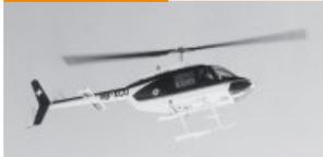
**Le Bell 206A, premier hélicoptère à turbine** Le Jet Ranger HB-XCU ne dispose pas de treuil. Seul un câble fixe permet de mener à bien des sauvetages en montagne quand l'atterrissage est impossible.
