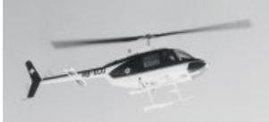
**Bell 206A, erster Helikopter mit Turbine** Der «Jet-Ranger» HB-XCU verfügt zwar über eine Turbine, aber nicht über eine Rettungswinde. Bergrettungen ohne Landemöglichkeit sind nur mit dem Fixtau möglich.
