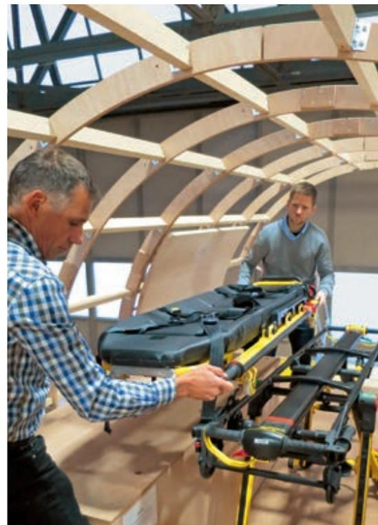
**Test im Mock-up des Challenger 650: Passt das Tragesystem der Ambulanzfahrzeuge auch auf die breiteren Intensivpflegestationen des neuen Rega-Jets?**
