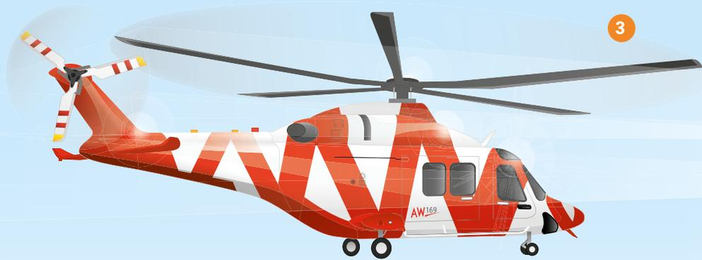
**Der künftige Rega-Helikopter AW169-FIPS ist der weltweit erste allwettertaugliche Helikopter mit einem Maximalgewicht von unter fünf Tonnen. Um die notwendigen Zulassungen zu erhalten, muss er bis zur Auslieferung auf Herz und Nieren getestet werden – unter anderem mit unzähligen Testflügen in einer künstlich erzeugten Eiswolke.**
